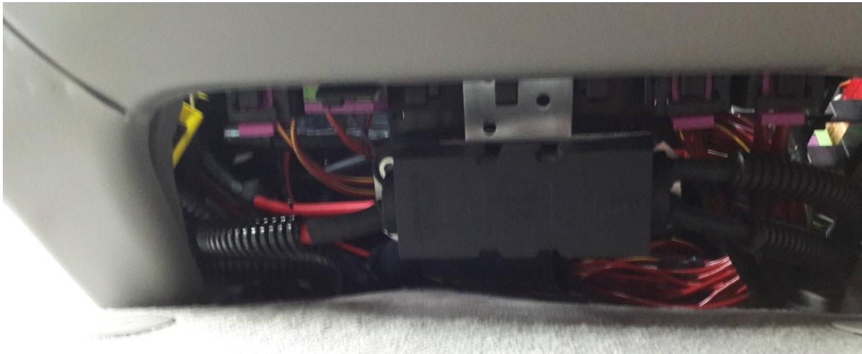
Montage des Winkels für Hochlastsicherung vom Sitzinnenraum nach vorne fotografiert:
